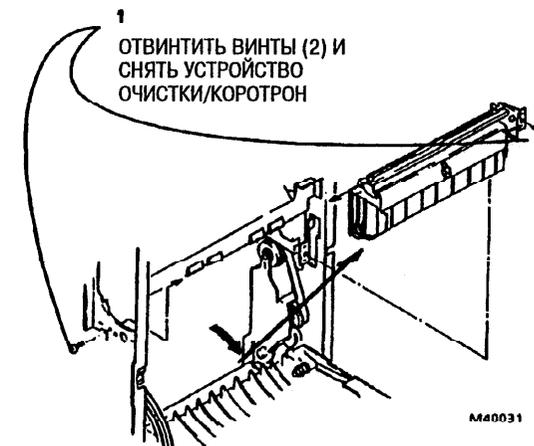
Рис. 1. Снятие устройства очистки/
